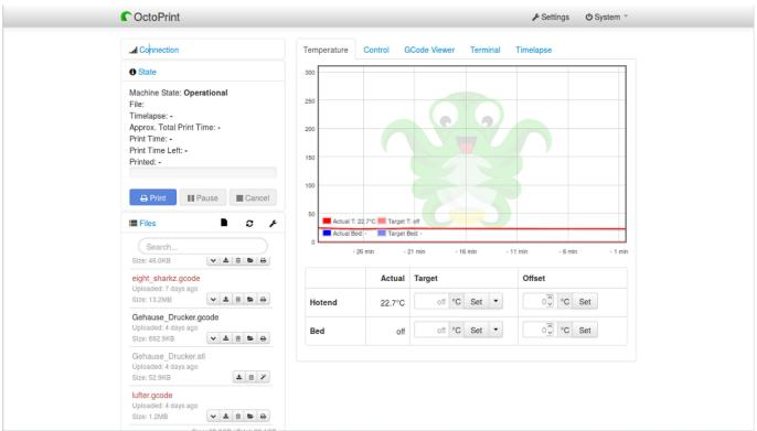
Sollte kein Drucker verbunden sein, muss man die Verbindung unter dem Reiter Connection noch herstellen. (Durch Klicken auf Verbinden.)
