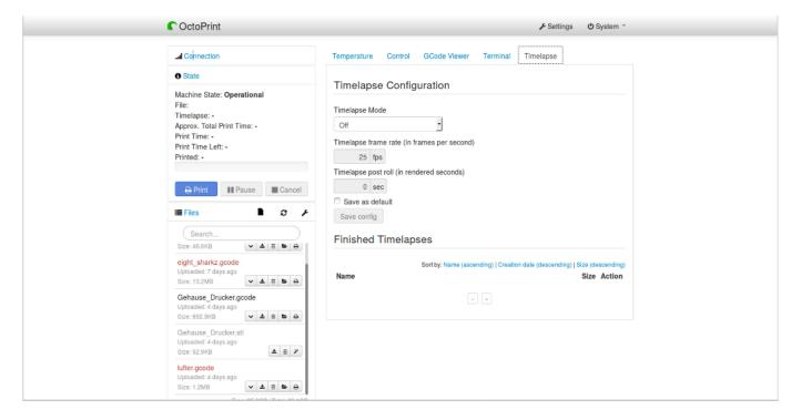
Links oben in der Titelleiste sind noch zwei Menüpunkte, Einstellungen und System vorhanden. Unter dem Menüpunkt Einstellungen können noch einmal die selben Druckerparameter verändert werden wie unter den Verbindungseinstellungen. Zusätzlich dazu sind wetere Features aber Einstellungen zu OctoPrint als Printserver oder aber auch die Softwareupdatemöglichkeiten abrufbar.
