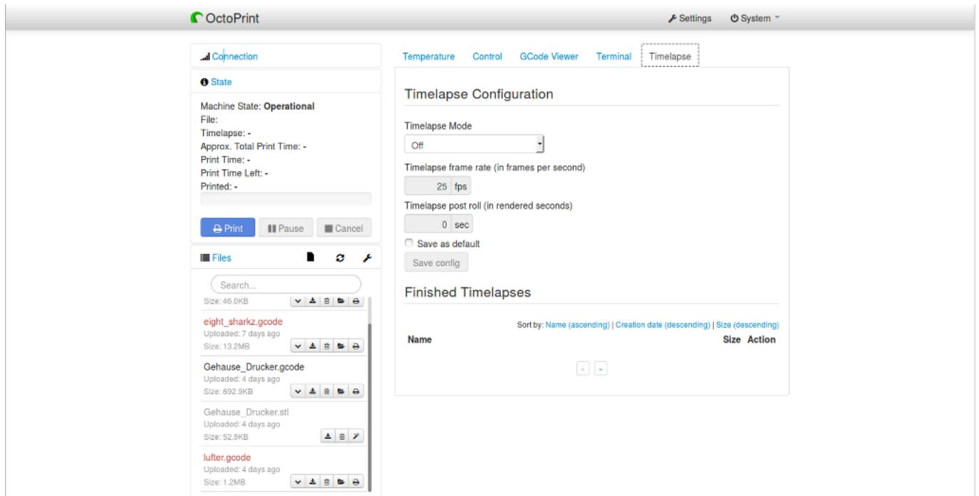
Links oben in der Titelleiste sind noch zwei Menüpunkte, Einstellungen und System vorhanden. Unter dem Menüpunkt Einstellungen können noch einmal die selben Druckerparameter verändert werden wie unter den Verbindungseinstellungen. Zusätzlich dazu sind weitere Features aber Einstellungen zu OctoPrint als Printserver oder aber auch die Softwareupdatemöglichkeiten abrufbar.
