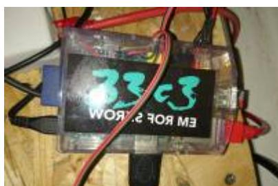
Das warpzone Radio ist ein [Raspberry Pi 1 B+](#) mit [Arch Liuux](#). Hier läuft ein MPD, auf einem USB Stick sind ein paar lizenzzfreie Songs gespeichert. Primär wird das radio genutzt um Webstreams oder Streams anderer (unabhängiger) MPDs abzuspielen.
