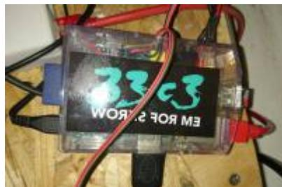
Das warpzone Radio ist ein [Raspberry Pi 1 B+](#) mit [Arch Liuux](#). Hier läuft ein MPD, auf einem USB Stick sind ein paar lizenzfreie Songs gespeichert. Primär wird das radio genutzt um Webstreams oder Streams anderer (unabhängiger) MPDs abzuspielen.
