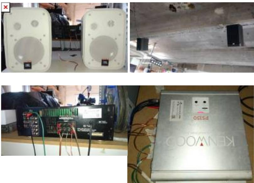
Das Audiosignal kommt vom Mischpult und geht in den Eingang der Autoendstufe. Sie betreibt die Bassteller und hier wird es passiv durchgeschaltet zum 4-Kanal-Verstärker. Dies funktioniert auch mit
