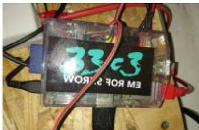
Das warpzone Radio ist ein [Raspberry Pi 1 B+](#) mit [Arch Linux](#). Hier läuft ein MPD, auf einem USB Stick sind ein paar lizenzfreie Songs gespeichert. Primär wird das radio genutzt um Webstreams oder Streams anderer (unabhängiger) MPDs abzuspielen.
