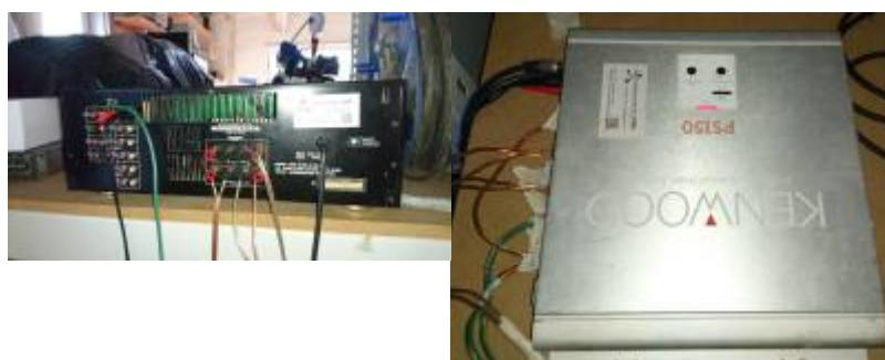
Das Audiosignal kommt vom Mischpult und geht in den Eingang der Autoendstufe. Sie betreibt die Bassteller und hier wird es passiv durchgeschaltet zum 4-Kanal-Verstärker. Dies funktioniert auch mit
