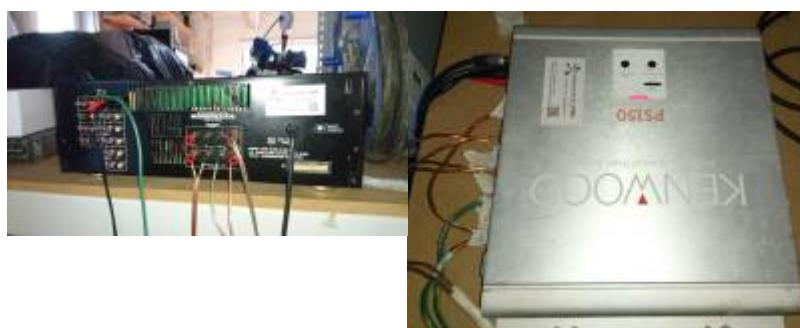
Das Audiosignal kommt vom [Mischpult](#) und geht in den Eingang der Autoendstufe. Sie betreibt die Basssteller und hier wird es passiv durchgeschaltet zum 4-Kanal-Verstärker. Dies funktioniert auch mit
