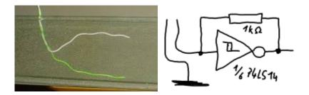
Dies Bild zweigt zwei Oszillogramme im Rotkanal ( mit Finger auf dem Glas ) und im Grünkanal ( ohne Finger ) in einem RGB-Bild übereinandergelegt ( 5 Mikrosek/DIV ):
