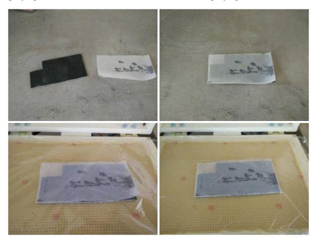
Nach dem Drucken sollte die Vorlage mit Tonerverdichter oder Solvent bearbeitet werden, da diese den Kontrast noch mal erhöhen. Dazu muss die Ätzvorlage mit einem von den beiden Mitteln eingesprüht werden.
