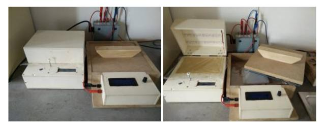
Das UV-Licht wird durch die Belichtungsvorlage auf den Fotopositivlack geschienen. Der Fotopositivlack auf den Platinen reagiert auf das UV-licht und wird später beim entwickeln an
