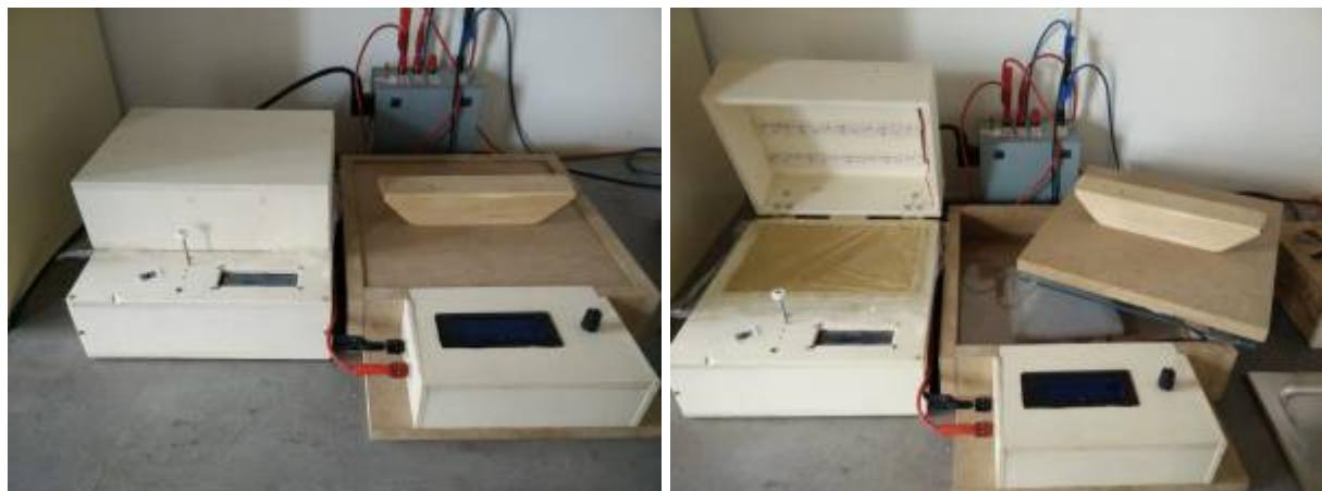
Das UV-Licht wird durch die Belichtungsvorlage auf den Fotopositivlack geschienen. Der Fotopositivlack auf den Platinen reagiert auf das UV-Licht und wird später beim Entwickeln an belichteten Stellen „abgespült“.
