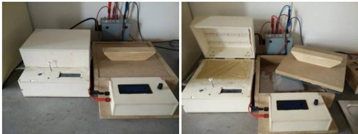
Das UV-Licht wird durch die Belichtungsvorlage auf den Fotopositivlack geschiene. Der Fotopositivlack auf den Platinen reagiert auf das UV-Licht und wird später beim entwickeln an belichteten Stellen „abgespült“.
