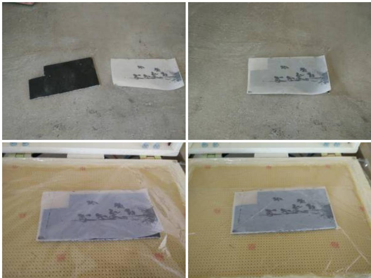
Nach dem Drucken sollte die Vorlage mit Tonerverdichter oder Solvent bearbeitet werden, da diese den Kontrast noch mal erhöhen. Dazu muss die Ätzvorlage mit einem von den beiden Mitteln eingesprüht werden.
