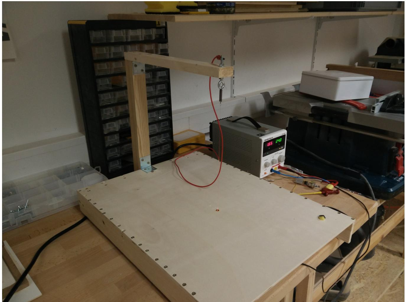
Das Gerät schneidet das Styropor mit einem heißen Draht. Dieser Draht besteht aus Konstantan (besser bekannt als Widerstandsdrat) welcher mit einem konstanten Strom durchflossen wird. Dadurch erwärmt er sich.
