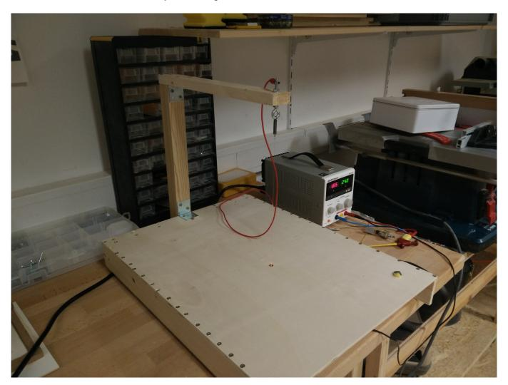
Das Gerät schneidet das Styropor mit einem heißen Draht. Dieser Draht besteht aus Konstantan (besser bekannt als Widerstandsdraht) welcher mit einem konstanten Strom durchflossen wird. Dadurch erwärmt er sich.
