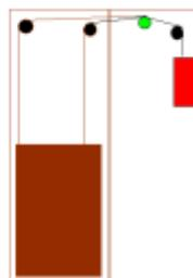
Die Tür hängt an 2 Stahlseilen/Fahrradketten, die über 2 Rollen/Ritzel geführt werden. Der Motor (grün) treibt die ganze Sache an und wird vom Kontergewicht (rot) entlastet.
