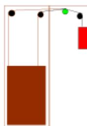
Die Tür hängt an 2 Stahlseilen/Fahrradketten, die über 2 Rollen/Ritzel geführt werden. Der Motor (grün) treibt die ganze Sache an und wird vom Kontergewicht (rot) entlastet.
