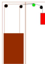
Die Tür hängt an 2 Stahlseilen/Fahrradketten, die über 2 Rollen/Ritzel geführt werden. Der Motor (grün) treibt die ganze Sache an und wird vom Kontergewicht (rot) entlastet. → Diese Türvariante lässt sich durch Anheben sehr einfach öffnen.
