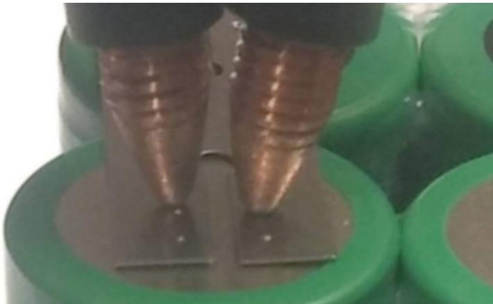
Während der Fußschalter nach dem Schweißen gedrückt bleibt bzw. die Elektroden auf der Schweißstelle bleiben, zeigt das Display Messwerte der Schweißstelle an, so wie die Zahl der Schweißungen seit Einschalten.
