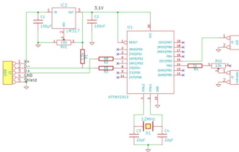
Der LM317 ist über RV1 so eingestellt das er die Spannung auf 3,1V regelt. Diese kann er auch noch aufrecht halten wenn die USB Spannung nicht ganz die 5V erreicht.
