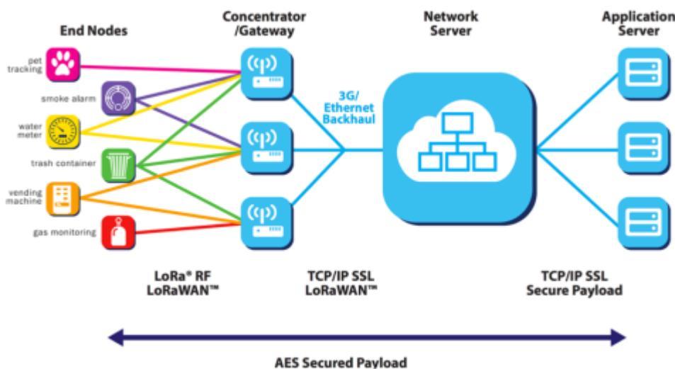
LoRaWAN läuft in Europa auf 868Mhz ISM und ist lizenzenfrei. Das Band ist aber reguliert, insbesondere Sendeleistung und Duty-Cycle. Eine Node darf max 1% Airtime nutzen. Details: [BNA "Funkanwendungen auf den ISM-Bändern"](#) (Warnung:PDF)
