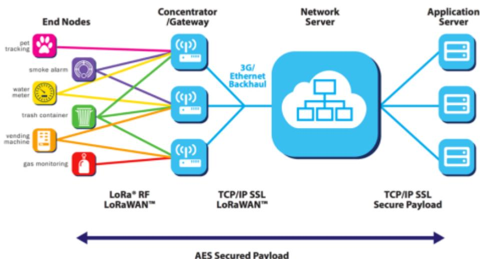
LoRaWAN läuft in Europe auf 868Mhz ISM und ist lizenzfrei. Das Band ist aber reguliert, insbesondere Sendeleistung und Duty-Cycle. Eine Node darf max 1% Airtime nutzen. Details: [BNA "Funkanwendungen auf den ISM-Bändern" \(Warnung:PDF\)](#)
